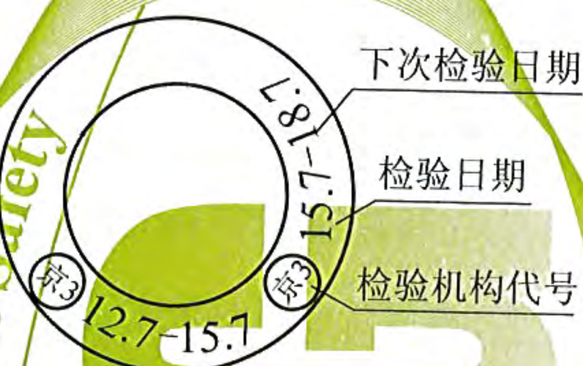
(b) 打在金属检验标志环的定期检验钢印标记
